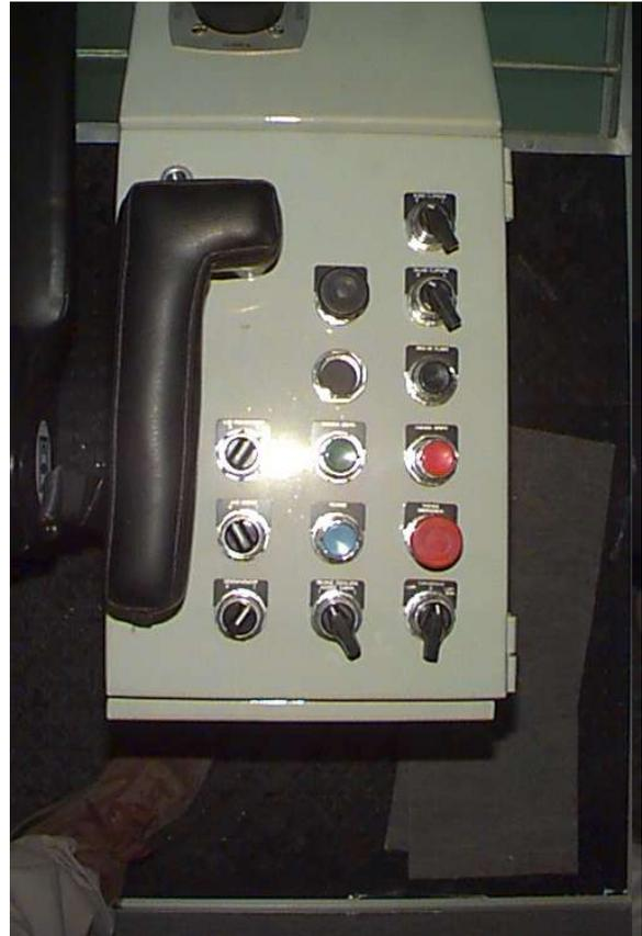
Los pupitres se han diseñado de forma que tienen un único armazón, con las conexiones eléctricas comunes a los paneles de las diferentes grúas. La parte superior de los pupitres es intercambiable facilitando y acelerando el intercambio de pupitres.
