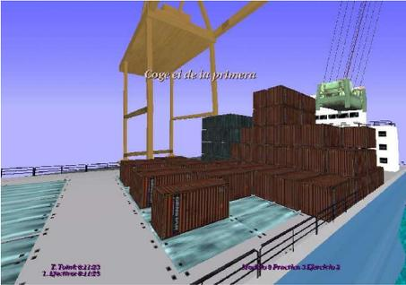
La solución propuesta por la Universidad de Valencia para la simulación de grúa pórtico permite simular el trabajo con las grúas pórtico de tipo Regiane OVER-PANAMAX y Paceco PANAMAX. Estas grúas están modeladas con todo detalle en sus diferentes aspectos, tanto físicos como de funcionamiento.
